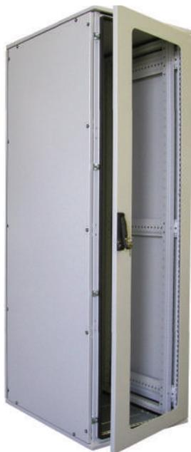
**Esempio TP.55.3V.60.80.42:** Questo codice, ricavato dalle celle evidenziate, identifica un rack 19" serie TP 60x80x197 da 42/U con protezione IP55 completi di telaio - 4 montanti 19" - 2 porte cieche - pareti laterali asportabili.
