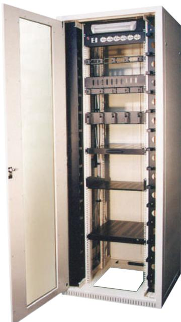
Questa serie di Rack a tecnica 19", ha una larghezza di 80 cm, è particolarmente indicata per installazioni con grandi quantitativi di cavi. Il maggiore spazio lungo i fianchi dell'armadio, utile per un'adeguata gestione dei cavi lateralmente alle apparecchiature, può ospitare delle canale verticali che razionalizzano ulteriormente la gestione delle permutate.
